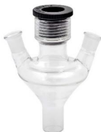
Naczynie reakcyjne 10 do 50 ml. Pojemność części dolnej: 10 ml Pojemność całkowita: 50 ml. Dwa ramiona boczne 14/20. Wysokość: 120 mm. Nr kat. 830-00012
