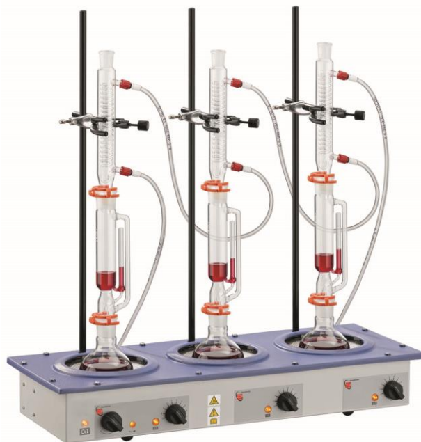
Model trzystanowiskowy z mieszadłami magnetycznymi. Uwaga: klamry i pokazane na zdjęciu zestawy szklane NIE stanowią wyposażenia aparatu.
